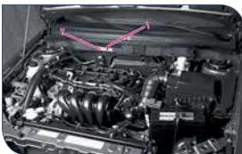
شماره شناسایی خودرو بدون محافظه موتور در قسمت بالای سمت چپ نامبرور "LF620" در تصویر بالا تعیین شده است و برای انجام کارهای قانونی مورد نیاز مالک خودرویی باشد. صفحه فلزی اطلاعات کارخانه سازنده به همراه شماره شناسایی خودرو "VIN" بر روی ستون وسط سمت چپ نیز نصب گردیده است.
