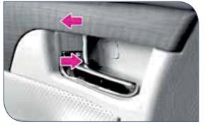
چنانچه سوئیچ داخل قفل فرمان مانده باشد و درب سمت راننده باز شد، نمی توان درب راننده را قفل نمود. حتی در صورتیکه دکمه قفل روی سستگرها داخلی درب سمت راننده، در موقعیت قفل قرار داشته باشد، باز هم می توان درب سمت راننده را باز نمود.
