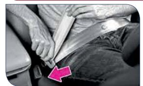
برای آزاد کردن کمربند ایمنی، دکمه روی قفل را فشار دهید. کمربند به طور اتوماتیک جمع خواهد شد. در صورتی که کمربند آهسته و به طور اتوماتیک جمع نمی شود، آن را بینون کشیده و عدم وجود گره یا جمع شدنگی را در آن کنترل نمایید. پس از برطرف شدن نقص، کمربند جمع می شود.
