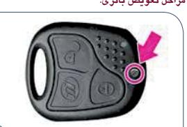
۱. با استفاده از پیچ گوشته چهار سو سوئیچ روی کنترل از راه دور را باز نمایید. با استفاده از پیچ گوشته سرتخت یا ابزاری مشابه کنترل از راه دور را باز نمایید.
