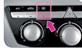
سوئیچ خودرو باید در وضعیت روشن "ON" قرار داشته باشد. سیم‌های گرم کننده درون شیشه عقب، به سرعت، سطح شیشه را تبیز خواهند کرد. چراغ نشانگر روشن شده، کارکرد گرم کن را نشان می‌دهد. با شماره جدد یکمه، گرم کن غیرفعال خواهد شد. پس از ۱۵ دقیقه کارکردن، گرم کن به طور اتوماتیک خاموش خواهد شد.
