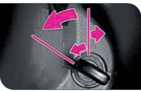
پس از قرار دادن سوئیچ خودرو در وضعیت "START" خودرو آماده استارت خودین می باشد. پس از رهگیر کردن، سوئیچ به طور اتوماتیک در وضعیت روشن "ON" قرار می گیرد. برای اطلاع از نحوه استارت زدن فصل ۲ را مطالعه نمایید.
