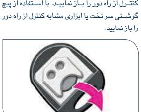
۱. استفاده از پیچ گوشته چهار سو سوئیچ روی کنترل از راه دور را باز نمایید. با استفاده از پیچ گوشته سرتخت یا ابزاری مشابه کنترل از راه دور را باز نمایید.
