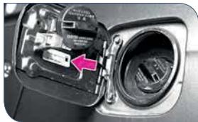
برچسب اکتان سوخت، داخل دریوش مخزن سوخت قرار گرفته است.
