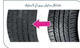
بيان زمان تعویض لاستیک مجهز می‌باشدند. در صورتی که آج لاستیک تا ضخامت ۷/۶ میلی‌متری کمتر سایده شود، نشانگر سایش بده می‌شود. در صورتی که بروای تعداد پیشتر از عالمین بین شیارها مشخص شده‌اند، تعویض لاستیک ضروری می‌باشد. هرچه میزان ضخامت آج لاستیک کمتر شود، اتحمل سرخورد و ترکیدن لاستیک افزایش می‌باشد.
