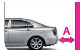
این سیستم فاصله بین خودرو و مانع را توسط چراغ نشانگر و آذیره‌شدار به راننده اطلاع می‌دهد. هنگام حرکت بنده عقب، دو حسکر التراسونیک، فاصله بین عقب خودرو و مانع را به مازول منتقل کرده، درنتیجه راننده از طریق چراغ و آذیره لحظه به لحظه از فاصله بین خودرو و مانع مطلع می‌گردد.
